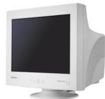
Система управления пучком заставляет пробегать его построчно весь экран (создает растр), а также регулирует его интенсивность (соответственно яркость свечения точки люминофора). Пользователь видит
