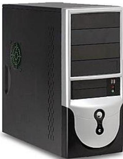
**Системный блок** – функциональный элемент, защищающий внутренние компоненты от внешнего воздействия и механических повреждений, поддерживающий необходимый температурный режим внутри, экранирующий создаваемое внутренними компонентами электромагнитное излучение.
