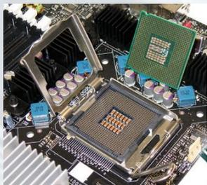
**ZIF** (от англ. *Zero Insertion Force* — нулевое усилие вставки) — разновидность процессорных и иных разъёмов, снабжённая подвижной планкой, управляемой рычагом и позволяющей устанавливать микросхемы с множеством контактов без существенных усилий.
