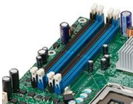
Рис. 4. Разъемы (слоты) для установки модулей ОП
