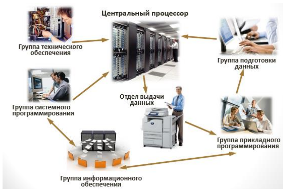
Рис. 1. Структура вычислительного центра на базе большой ЭВМ
