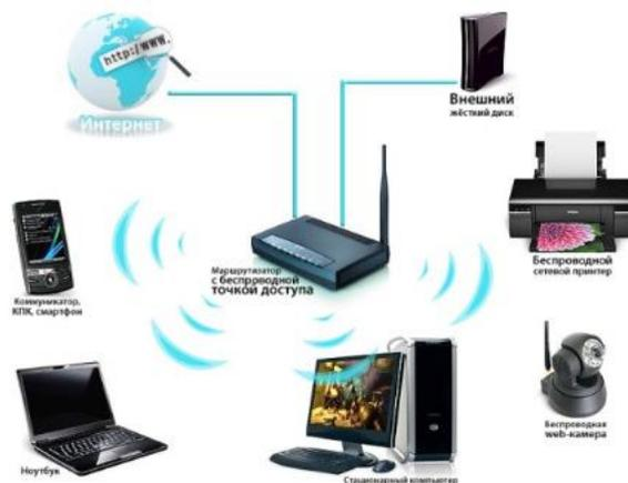
**Wi-Fi** (*Wireless Fidelity*, дословно перевести как «беспроводное качество» или «беспроводная точность») — технология обеспечивающая подключение мобильных пользователей к Интернету. Характеризуется невысокой дальностью передачи данных.
